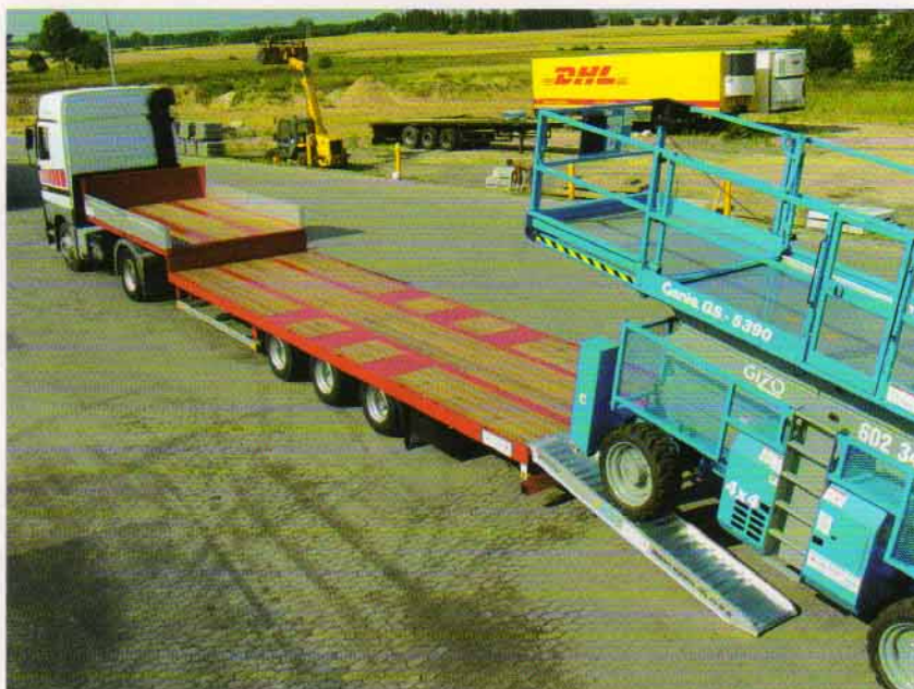
Na obydwu zdjęciach: niskopodłogowa naczepa Pacton typu Jumbo
