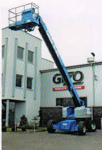
Teleskopowe ramie podnosi ludzi na wysokość nawet 28 m
