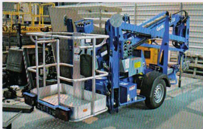
Nowością na naszym rynku są przyczepkowe pomosty teleskopowe o wysokości do 14 m. Mogą je ciągnąć nawet auta dostawcze
