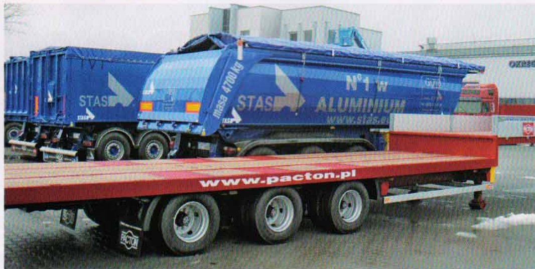
Aluminiowe wywrotki belgijskiej firmy Stas dzięki swojej małej masie pozwalają na przewóz od 1,5 do 2 ton ładunku więcej. Paction to solidne naczepy platformy, skrzyniowe i kurtynowe
